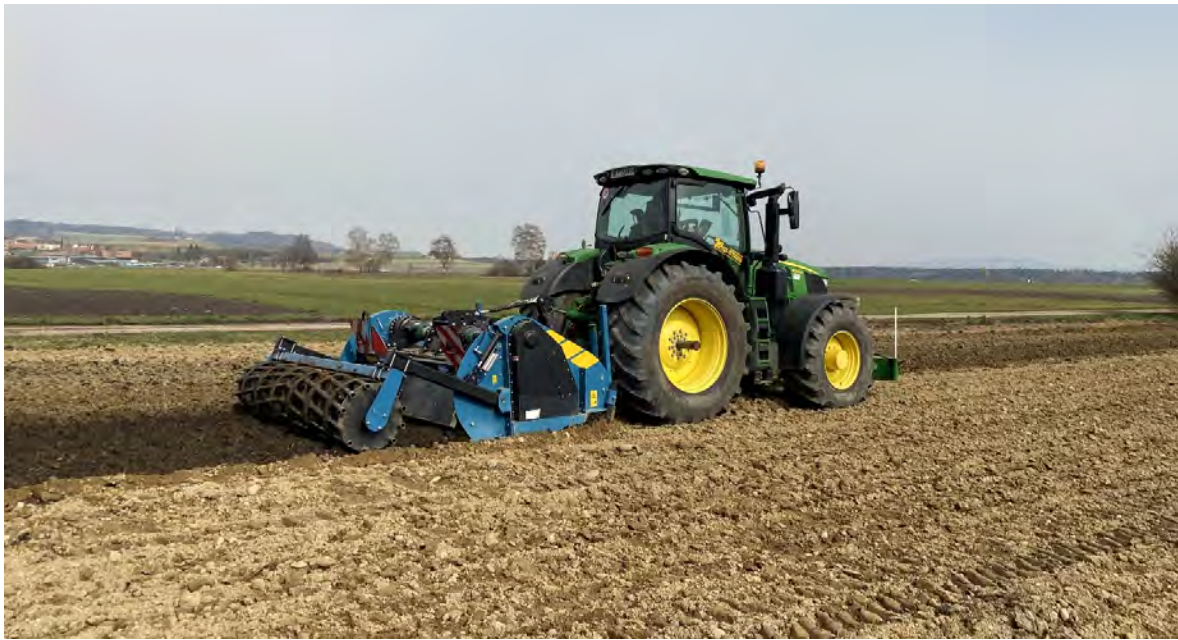
Abb. 6: Einmischen von überschüttetem Mineralboden in den gewachsenen, anmoorigen Boden mit der Rotationsspatenmaschine (Aufnahmedatum: 17.03.2022).
